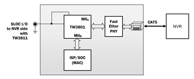
FIGURE 5. SLOC EMBEDDED IP CAMERA DESIGN BLOCK
