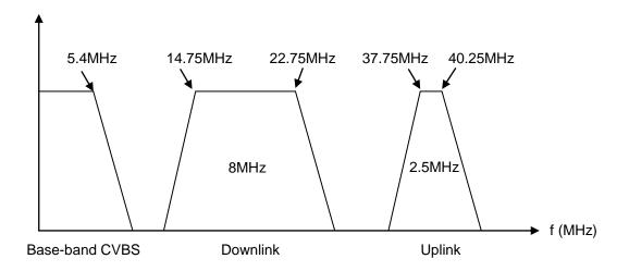
FIGURE 1. SLOC SIGNAL SPECTRUM
